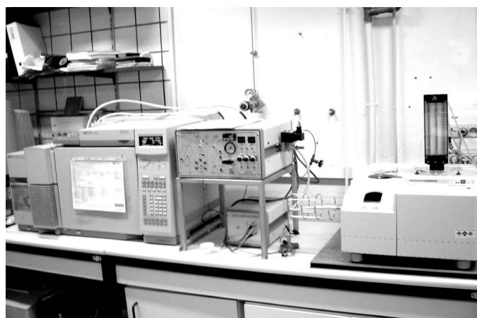
Fig. 2 Vue générale de l'ensemble TG/GC-MS
